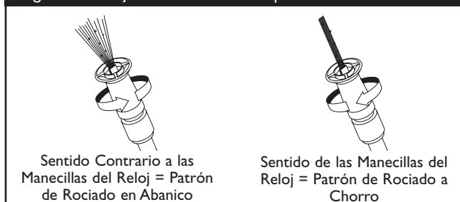
Figura 29 — Ajustar el Patrón de Aspersión
